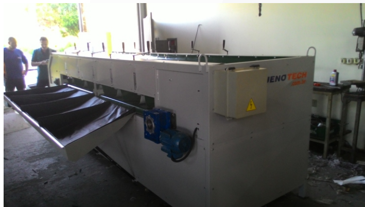
Calibrador de roletes com banca de corvím
