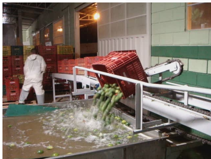
Tombador de caixas trabalhando
