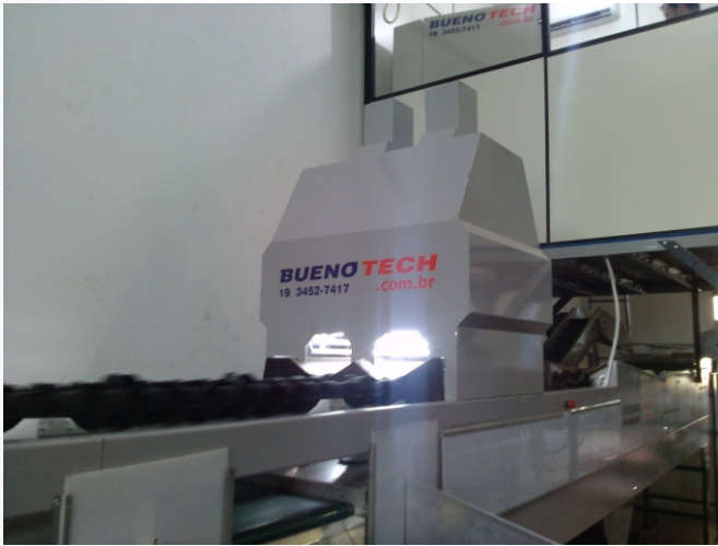
Calibrador eletrônico - cor, tamanho, diâmetro
