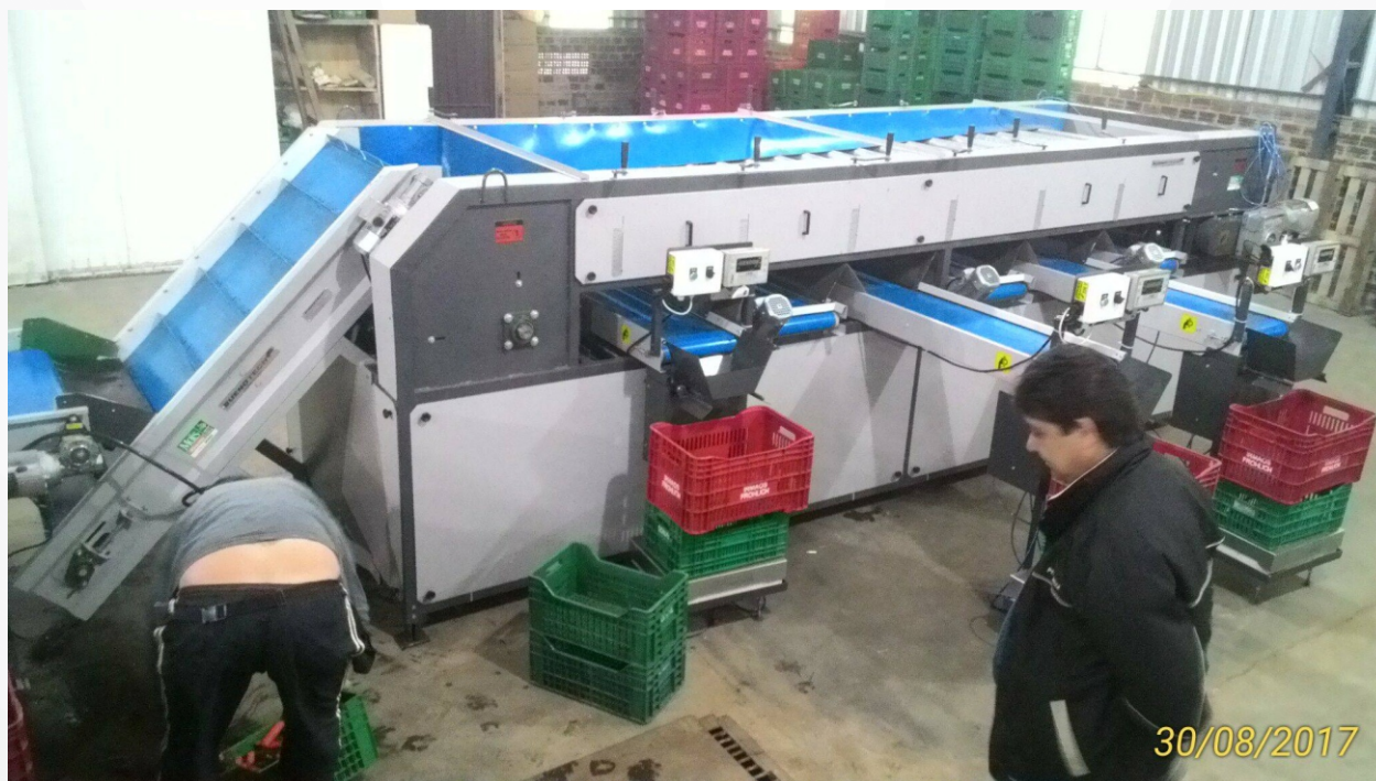
Calibrador de rolos com abertura de saco pneumático e sistema de pesagem com sistema de corte
