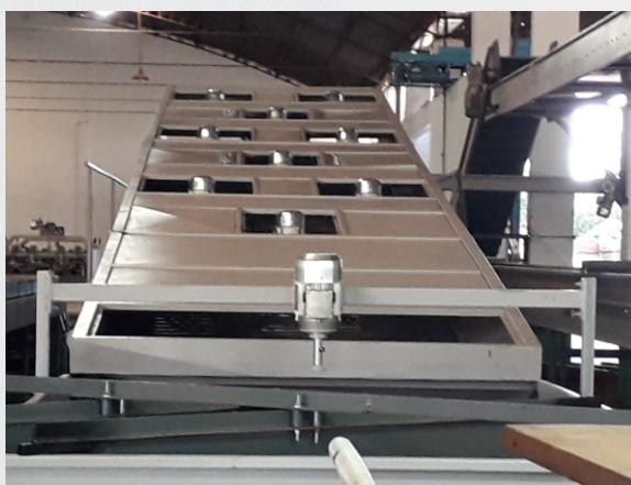
Secador com ventiladores
