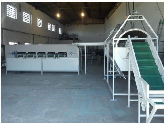
Calibrador de roletes com lavador cilíndrico
