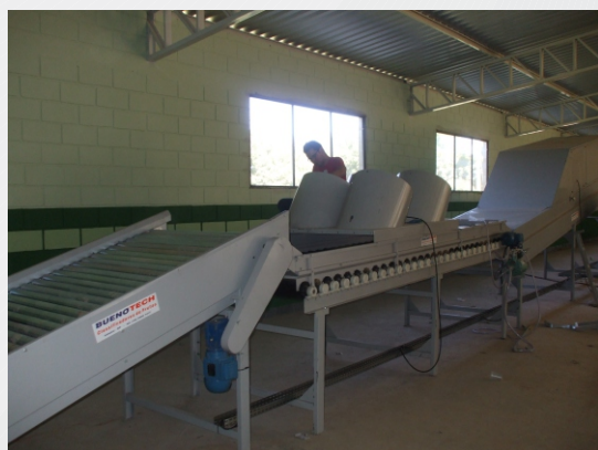
Esteira de entrada de roletes, pré-secador e Secador horizontal para citrus
